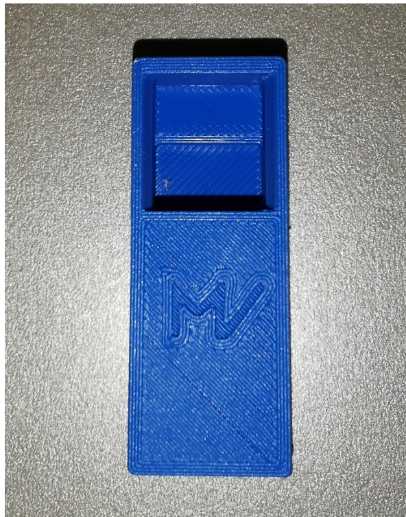
Slika 5. DHT11 kućište izrađeno tehnikom 3d ispisa
