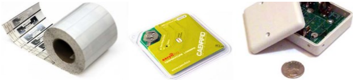
Slika 3. Primjeri RFID transpondera (pasivni, polupasivni i aktivni) [4]
