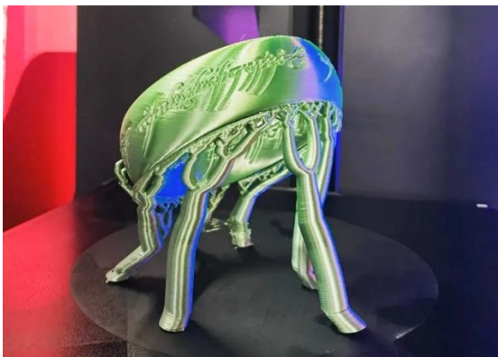
Slika 10. Primjer Tree Support tehnike [10].
