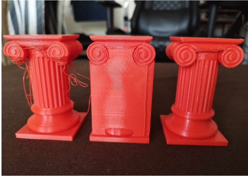
Slika 20. Lijevi model ispisan bez potpore, dok su srednji i desni ispisan pomoću njih[20].
