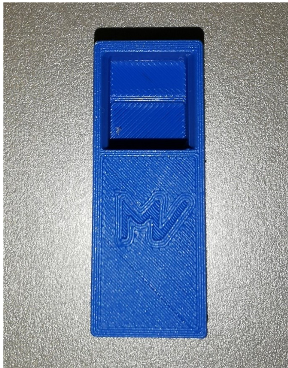
Slika 5. DHT11 kućište izrađeno tehnikom 3d ispisa
