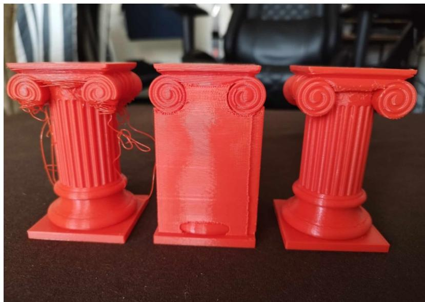
Slika 20. Lijevi model ispisani bez potpore, dok su srednji i desni ispisani pomoću njih[20].
