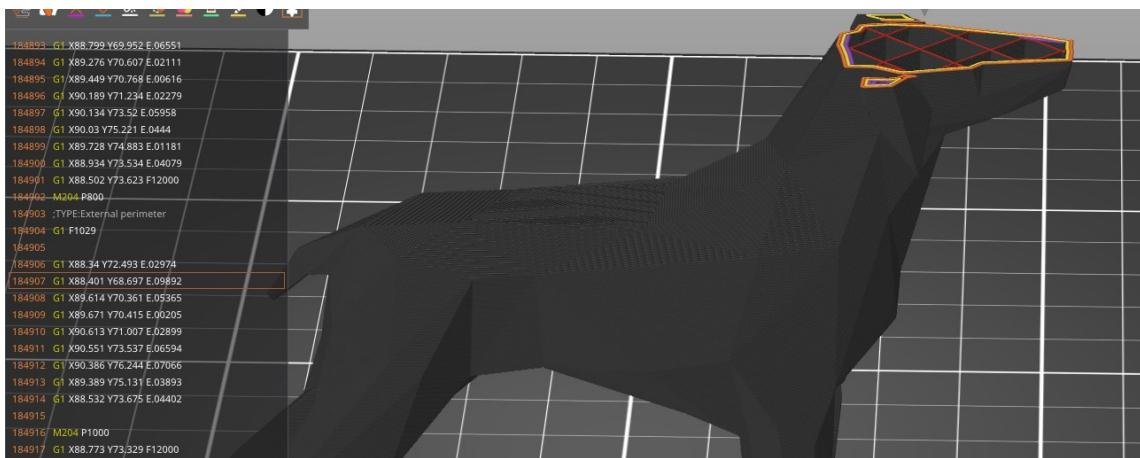
Slika 6. Prikaz g-koda na primjeru modela psa [6].
