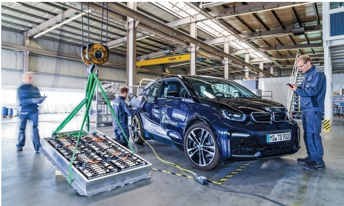
Slika 3. Baterija električnog automobila Bmw-a i3
