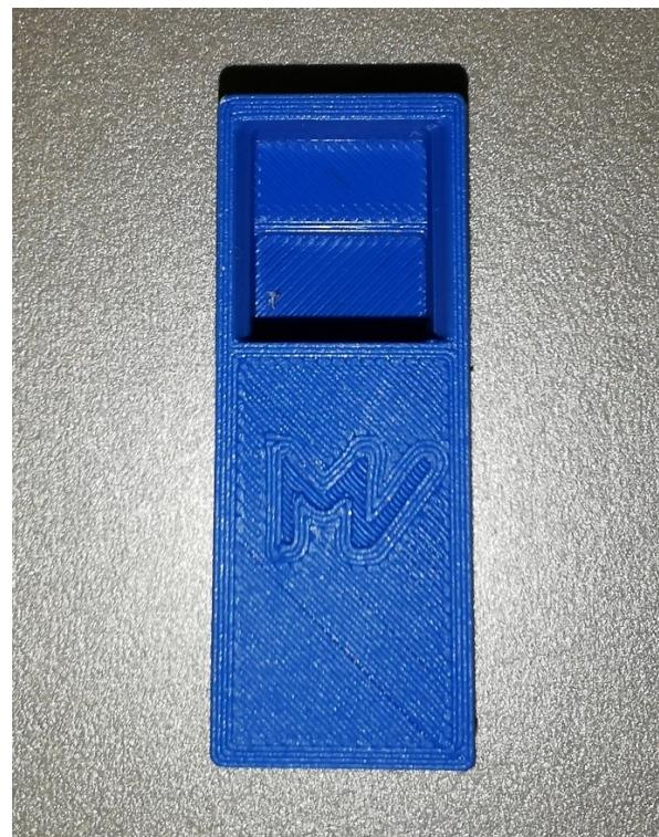
Slika 5. DHT11 kućište izrađeno tehnikom 3d ispisa
