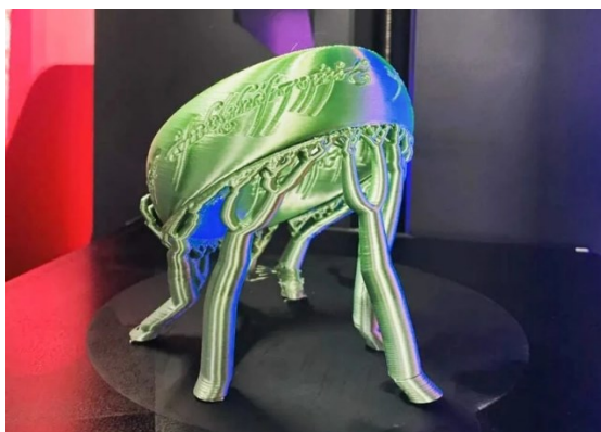
Slika 10. Primjer Tree Support tehnike [10].
