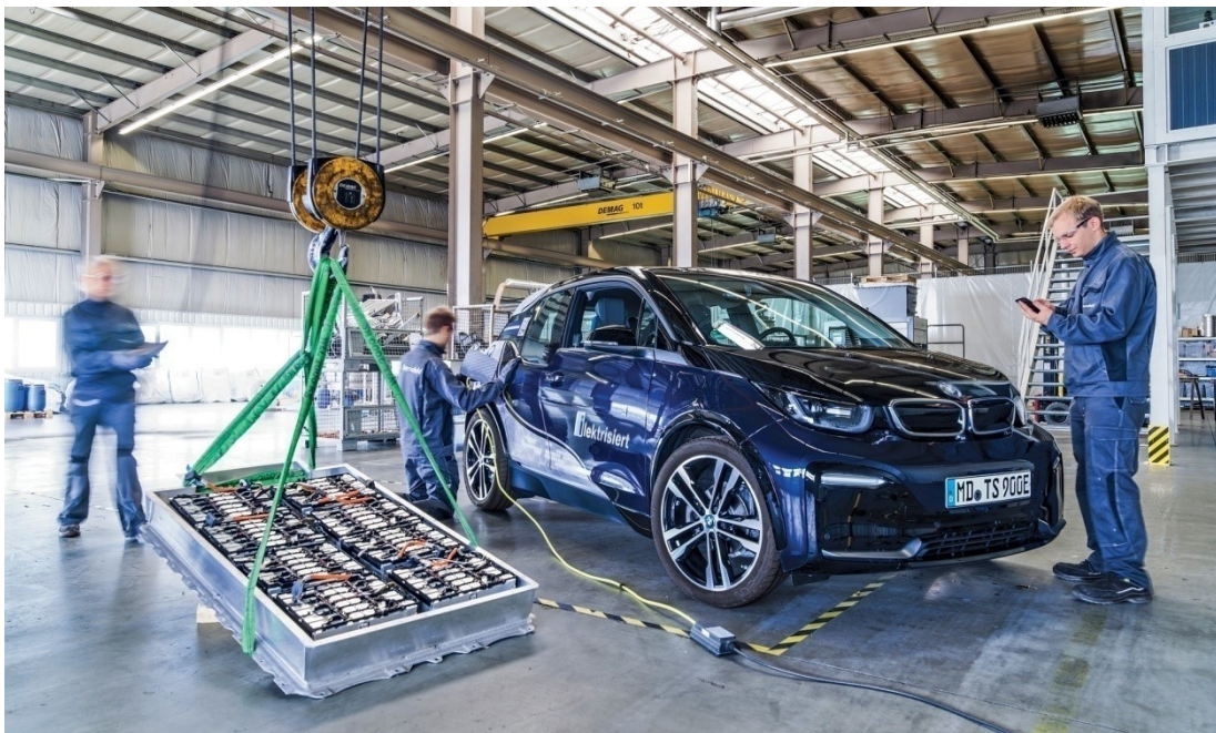
Slika 3. Baterija električnog automobila Bmw-a i3
